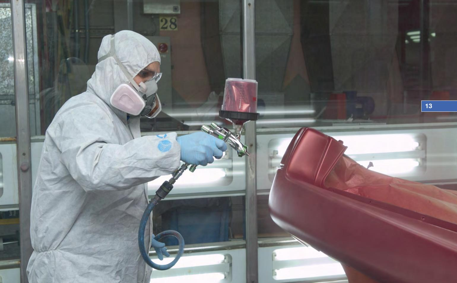
Aunque esta operación corresponde al proceso de pintura de acabado, en realidad se debe realizar antes de la preparación del aparejo, ya que en la formulación del código de color escogido el fabricante indicará si para facilitar su cubrición es preciso aplicar un tono determinado de fondo o aparejo.
