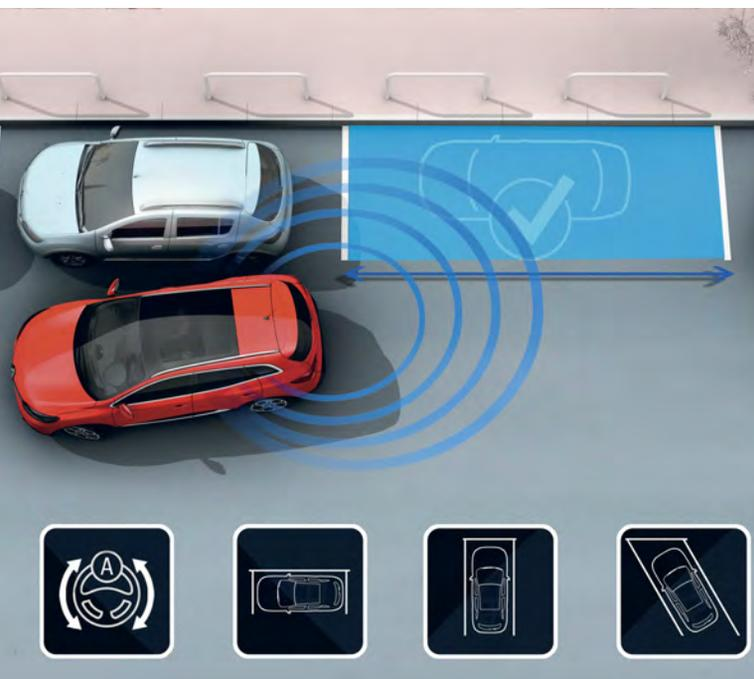
Una vez mostrado el interés de iniciar la maniobra de aparcamiento, se indicará al conductor que engrane la marcha atrás (si la distancia de aparcamiento no es suficiente, se indicará al conductor que previamente se desplace un poco hacia adelante) y que controle la velocidad del vehículo mediante acelerador y freno.
